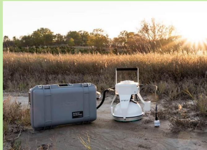
В ПОЛЕ: ИЗМЕРЕНИЕ ПОЧВЕННОЙ ЭМИССИИ CO 2
